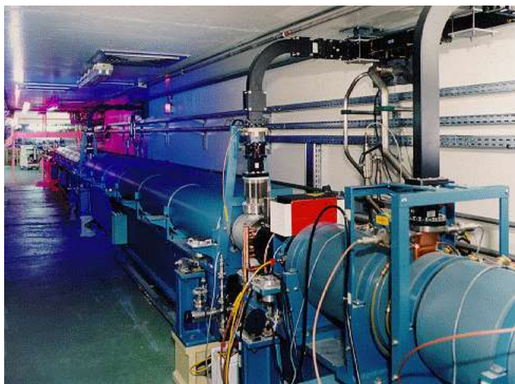
De lineaire versneller (12 m lang) waarmee de elektronen versneld worden voor dat ze het grote synchrotron ingaan.
